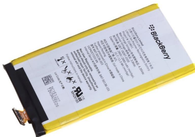
Obr. 3.9 - Baterie mobilního telefonu BlackBerry Z30, Li-Pol, 3,8V, 11Wh (zdroj: BlackBerry)
