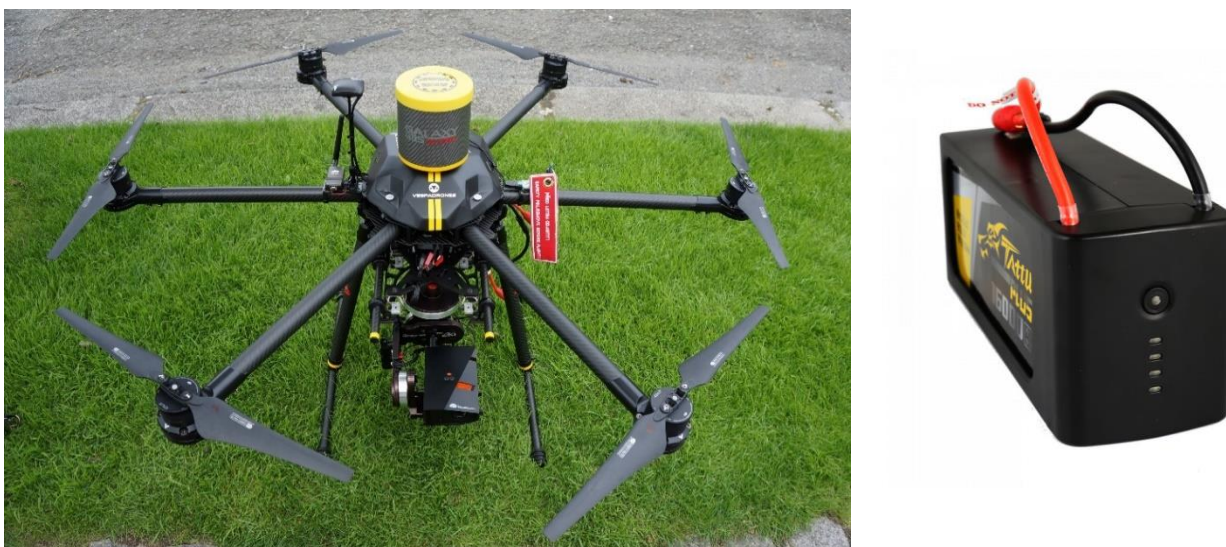
Obr. 3.13 – Vlevo bezpilotní vrtulník Vespadrone Xyris 6 s termokamerou Workswell Wiris vzletová hmotnost 8800g; Vpravo jeho pohonná baterie, Li-Pol, 16Ah, 22,2V, 355Wh, 2063g, 172 \text{ Wh}\cdot\text{kg}^{-1} , umožňující let po dobu 18 min (zdroj: archiv Mensuro Flying Machines)
