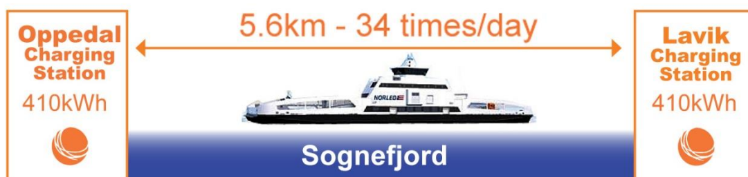
Obr. 3.12 – Vizualizace cyklického provozu elektrického trajektu Ampere [5]
