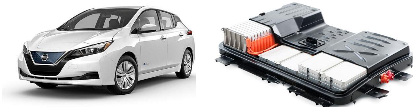
Obr. 3.11 - Elektromobil Nissan Leaf, vpravo baterie tohoto vozu, 30kWh, 192 Li-Ion (NMC) článků, které dosahují hustoty okolo 170Wh/kg, v reálném provozu tomuto elektromobilu umožňují ujet 200 km (zdroj: AESC - Automotive Energy Supply Corporation)
