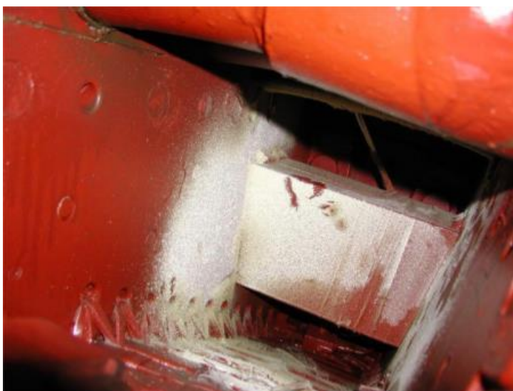
Obr. 2.2 Izolace ve formě bílého prachu sedřená z čel vinutí třením a vibracemi[18]
