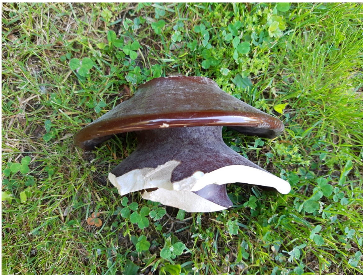
Obr. 6: Spadlý keramický izolátor, zdroj autor
