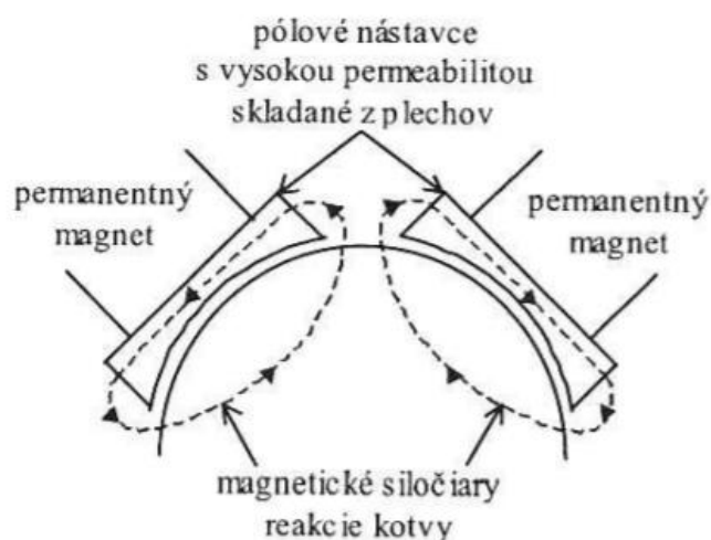
Obr. 4.2 Vodivé cesty pro magnetický tok reakce kotvy, převzato z [1]
