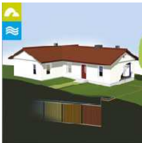
Obr. 2.6 TČ Země/voda – větrací vzduch [12]
