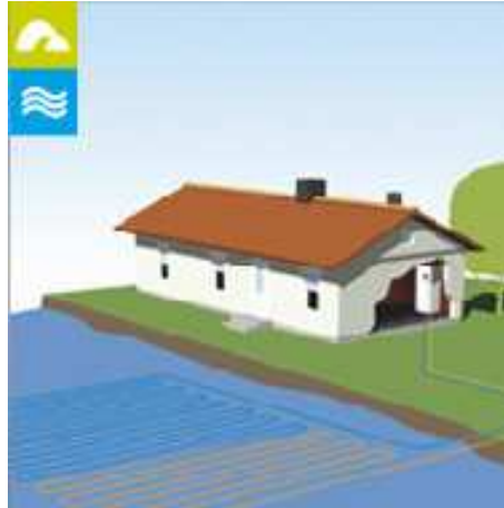
Obr. 2.7 TČ Země/voda – vodní plocha [12]
