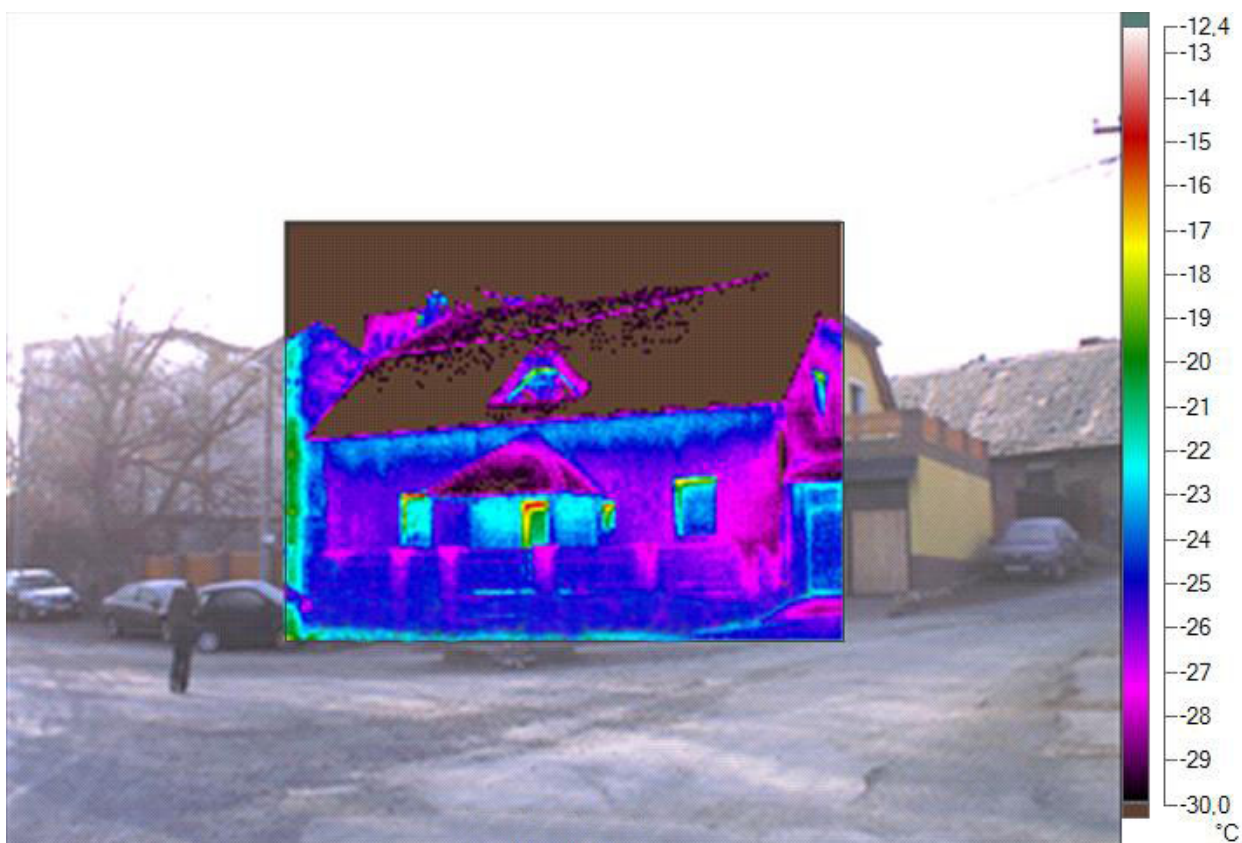
Obr.2 Pohled sever - proložení digitálního snímku termogramem
