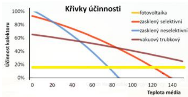
Graf 3: Srovnání křivek účinnosti při standardních podmínkách pro testování fotovoltaických článků (teplota okolí 25 °C, intenzita záření 1000 W/m 2 ) [17]
