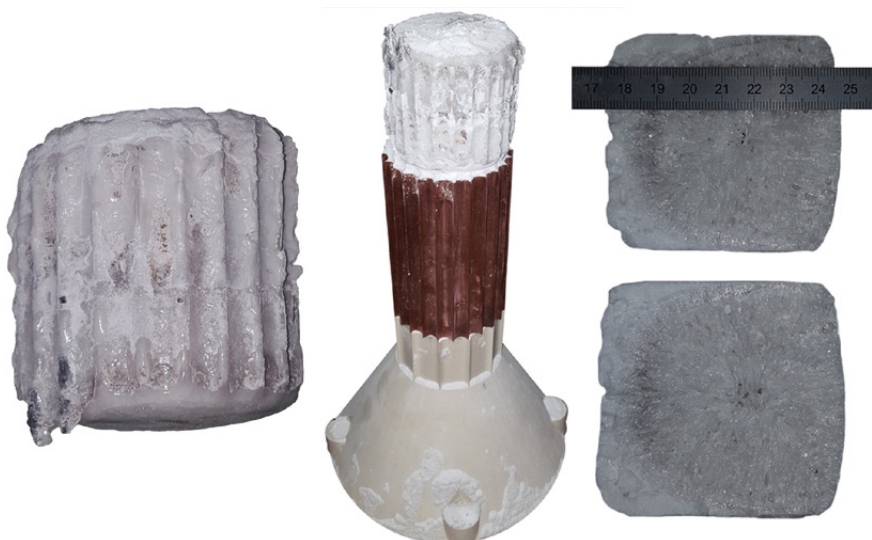
Obr. 3: Vlevo je celý ingot po vyjmutí ze studeného kelímku, uprostřed je vidět ingot stojící na odstrojeném studeném kelímku (podstavec, měděné dno, ingot), vpravo pak vnitřek ingotu po jeho rozdělení na dvě poloviny.
