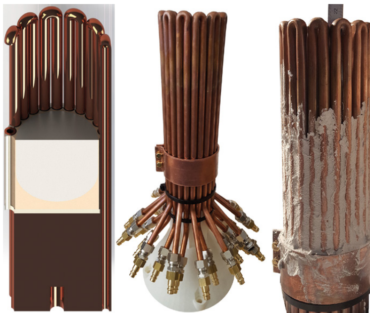
Obr. 2: Zobrazený studený kelímek je tvořen naohýbanými měděnými trubkami o vnějším průměru 10 mm (2 mm tloušťka stěny). Tyto trubice jsou prostřednictvím bandáže přitlačeny do axiálních povrchových drážek masivního měděného dna. V levé části obrázku je zobrazen vyrenderovaný model řezu studeným kelímkem, na modelu je orientačně prostorově znázorněna také tavenina (bílá) a skull vrstva (žlutá). Uprostřed je celkový pohled na reálný studený kelímek. V pravé části obrázku je znázorněn studený kelímek připravený na tavení (mezery mezi segmenty jsou vyplněny hmotou vsázky).
