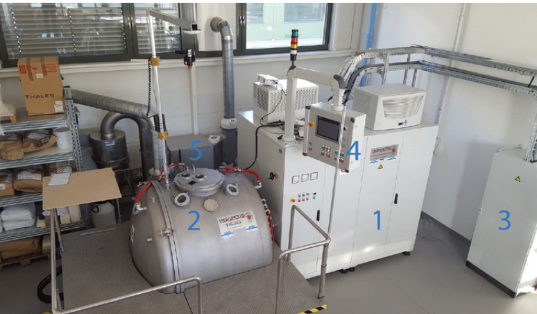
Obr. 1: Přehledová fotografie laboratoře se zařízením pro tavení ve studeném kelímku. Čísly jsou označeny hlavní součásti zařízení. 1 frekvenční měnič, 2 vakuovatelná pracovní komora, 3 elektrický rozvaděč, 4 řídicí panel, 5 filtrační systém pracovní komory. Na obrázku není vidět chladicí systém, který je na protilehlé straně.
