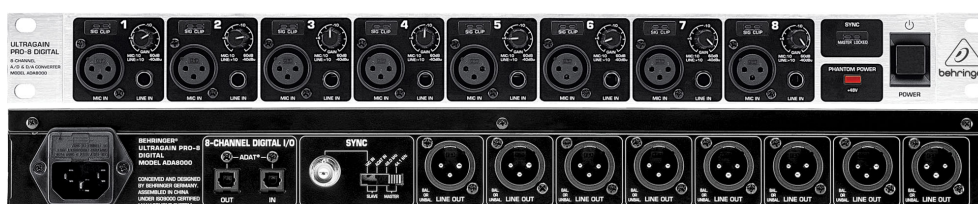
Obr. 19: Mikrofonní předzesilovač s AD převodníky ADA8000 od výrobce Behringer, který byl zvolen pro přestavbu [18].
