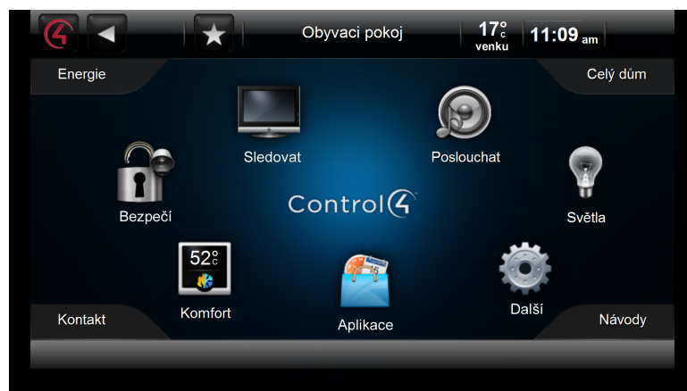
Obrázek 12: Nástěnný dotykový panel Control4 s rozhraním.
