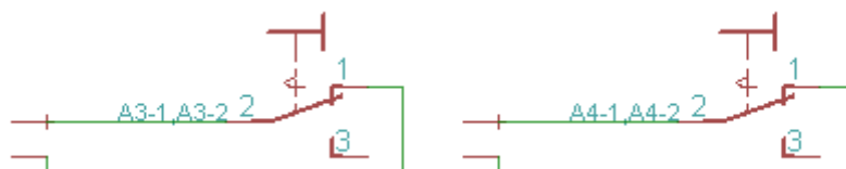
Obr. 10: Schéma zapojení tlakového spínače TUV a topné vody
