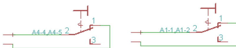
Obr. 8: Schéma zapojení hlavního vypínače a přepínače LÉTO-ZIMA
