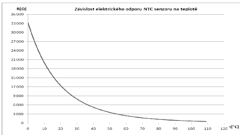
Obr. 21: Grafické znázornění elektrického odporu v závislosti na teplotě
