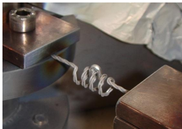
Obrázek 2.7.2 schématické znázornění vlákna [8] ukázka umístění hliníku na vlákno
