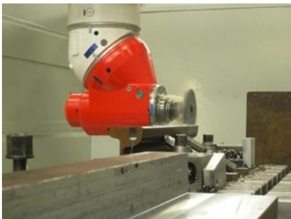
Obr. 18: Obráběcí hlava při obrábění traverzy (v době zkušebního provozu)
