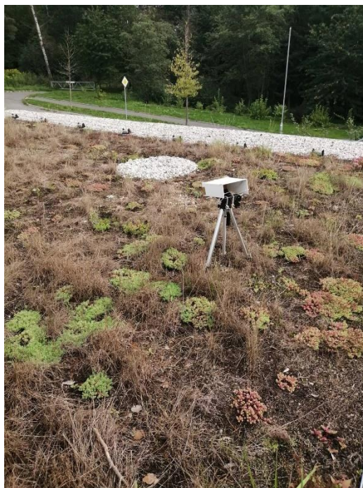
Obrázek 20: Přístroj Kestrel 5000 umístěný na ozeleněné střeše garáže rodinného domu v Letkově
