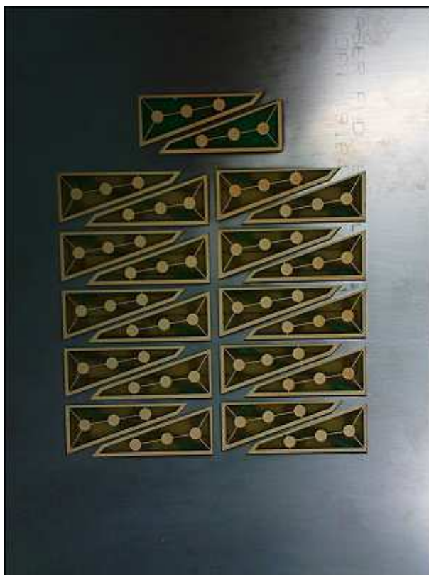
Obr. A.1.5. Nerezová šablona přiložená na PCB.
