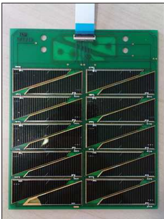
Obr. A.1.3. Deska PCB osazená – TOP.
