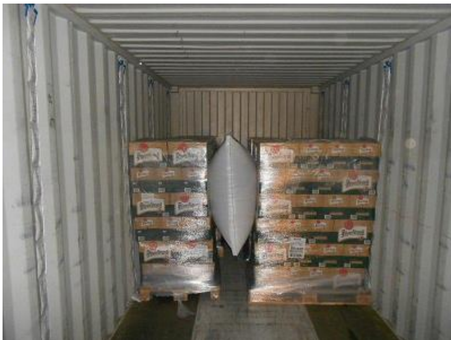
Obr. č. 22 – Vaky zajišťující fixaci zboží
