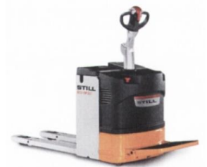
Obr. 12 - Vozík se stojící nebo kráčející obsluhou
