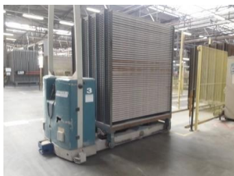
Obr. 29 - Indukčně vedený vozík (AGV) vezoucí zásobník
