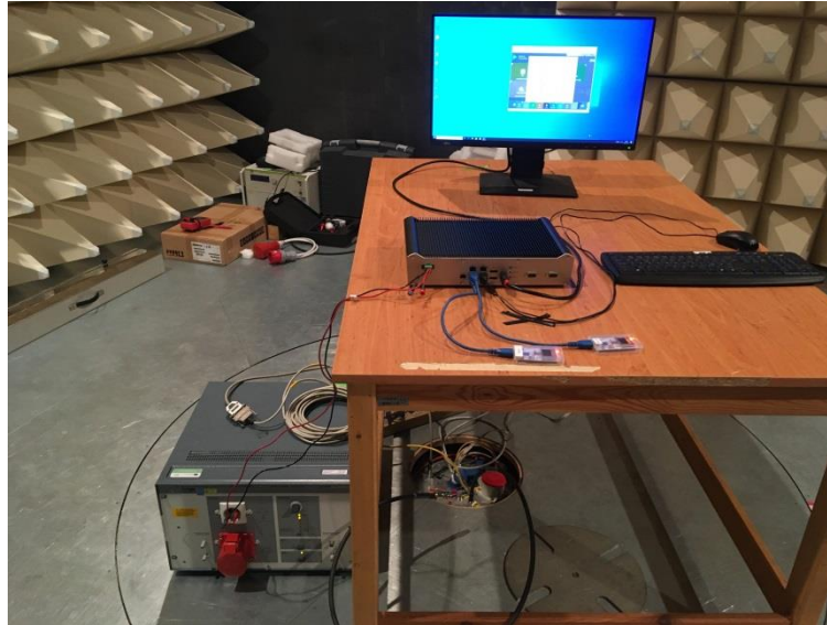
Obrázek 44 : Rozvržení měřicího pracoviště pro měření proudových emisí systému
