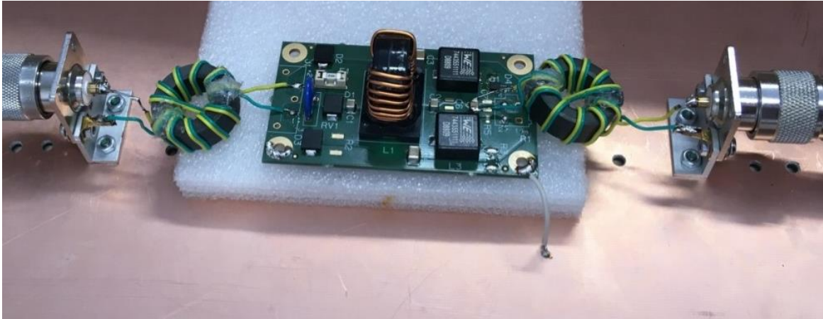
Obrázek 42 : Uspořádání pro měření potlačení symetrické složky rušení
