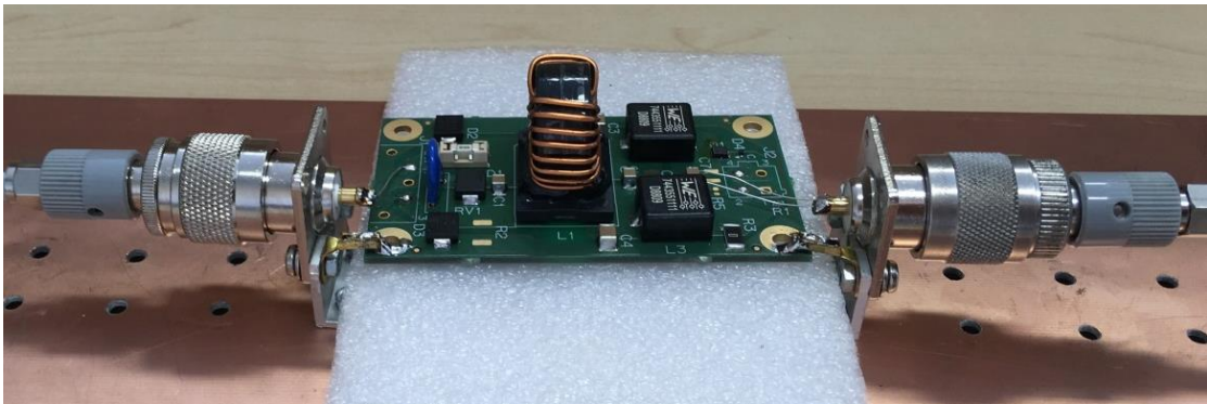
Obrázek 39 : Uspořádání pro měření potlačení nesymetrické složky rušení
