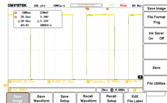
Obrázek 86 - Výstup z osciloskopu při měření parametrů relaxačního generátoru č.3 při 3,3 V
