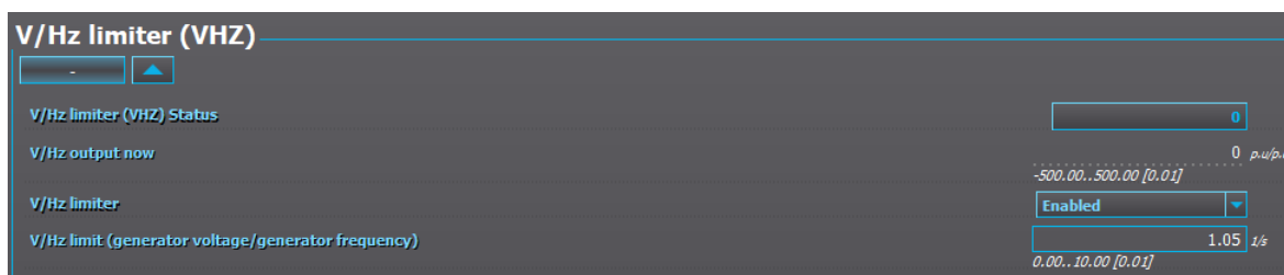
Obr. 35 - Nastavení omezovače proti přesycení v programu AQtivate
