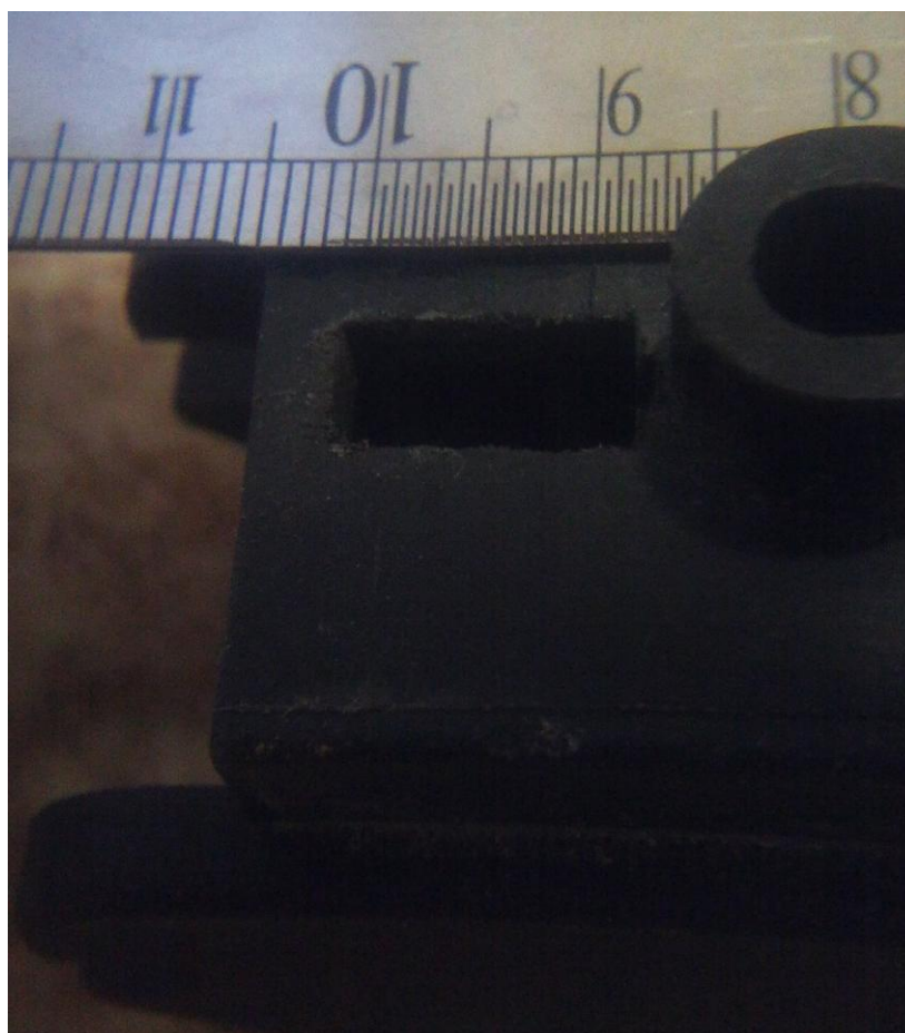
Obr. 3: Otvor v zásobníkové šachtě
