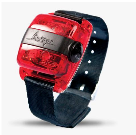
Obrázek 1 - Akcelerometr ActiGraph wGT3X-BT
