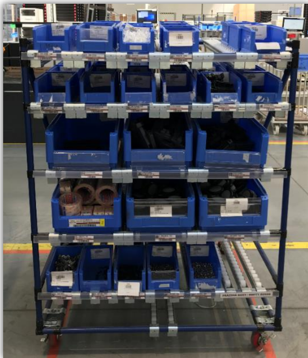
Obr. 38: Ukázka kanbanového regálu se spádovým systémem a boxy
