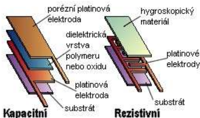
obr 4.2.3.1 kapacitní a rezistivní vlhkoměr
