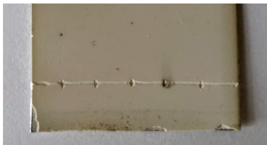
Obrázek 34: vrypy na rýze v plastince k chromatografii
