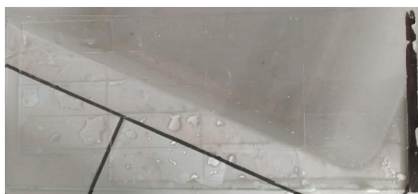
Obrázek 30: vyrovnaná sklíčka pro nalití směsi
