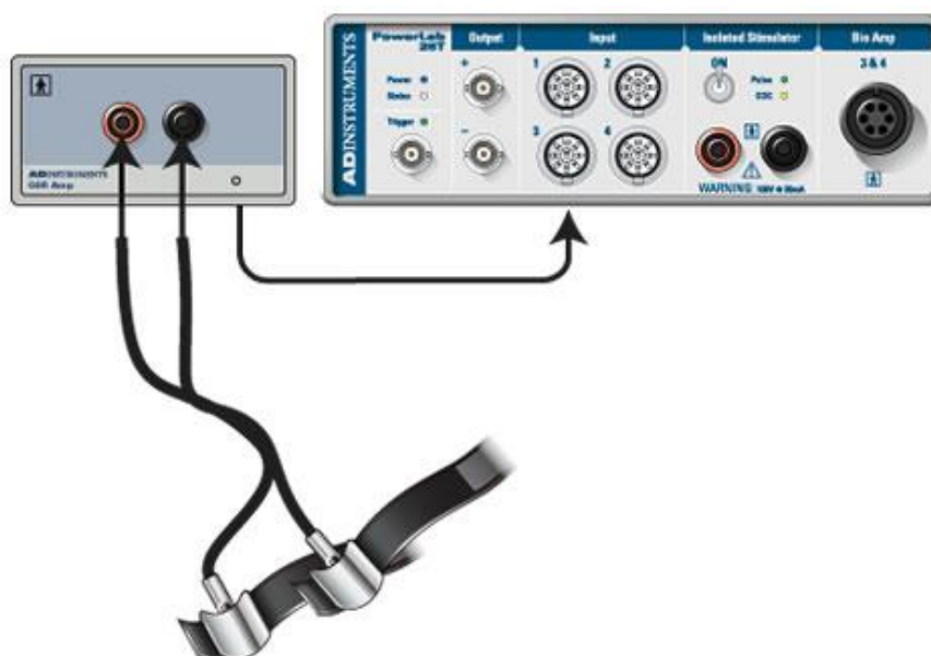
Obrázek 6: Schematické znázornění měřicího přístroje ADINSTRUMENT Power Lab spolu se zesilovačem ML 116 GSR Amp a elektrodami ( www.adinstrument.com ).
