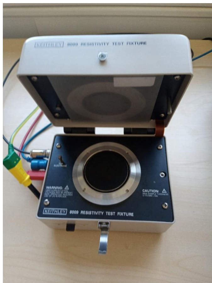
Příloha G: KEITHLEY 8009 Resistivity test fixture (pohled do přístroje).
