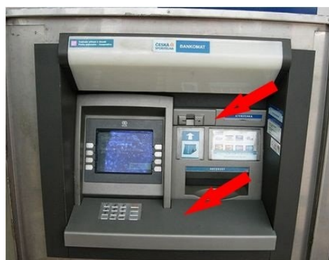
Obr. 6: Bankomat, šipky znázorňují skimmovací zařízení
