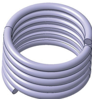
Obrázek 19 - Pružina pro E4 napínač
