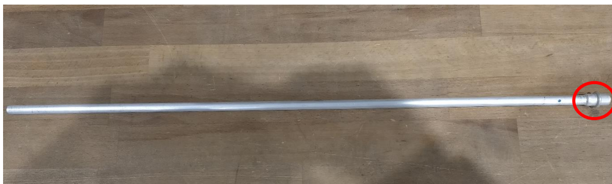
obr. 5-6: Trubka Al 3003, ze kterých byly připravované vzorky. Na pravém konci se nachází „límec“.
