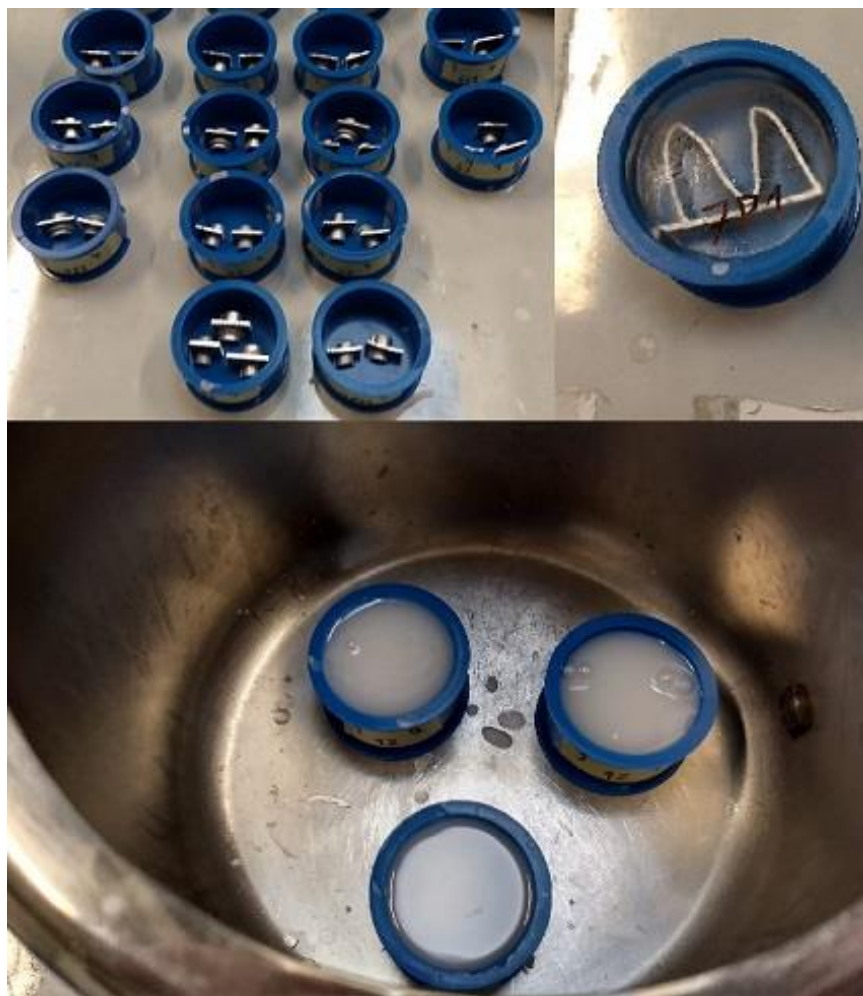
obr. 7-2: Zalévání vzorků do resinu. Vlevo, připravené vzorky na zalití. Dole, zalité vzorky uložené do tlakového hrnce. Vpravo, vzorek po vytuhnutí.
