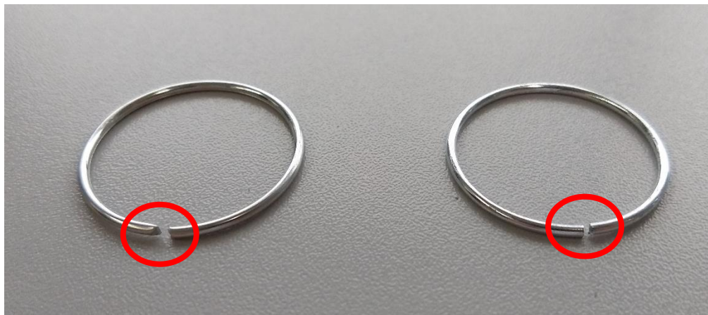
obr. 5-12: Neupravené pájecí kroužky. Vlevo kroužek bez fluxu, vpravo s fluxem.
