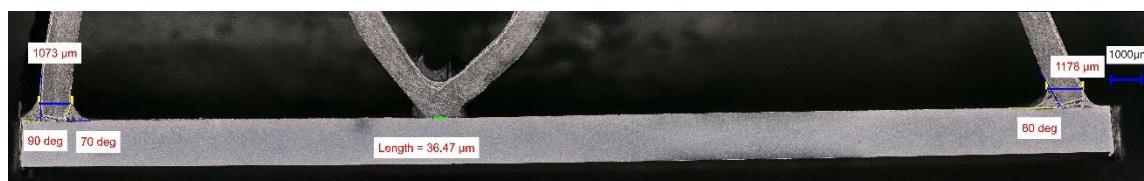
obr. 7-10: Vzorek 7Z-1 po změření délek spojů. Měřítka je 1000 \mu\text{m}
