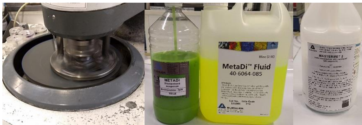
obr. 7-3: Vlevo, průběh leštění na brusce. Uprostřed, diamantová suspenze a smáčedlo. Vpravo, leštící suspenze \text{SiO}_2 .
