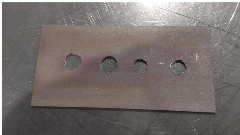
obr. 5-9: Necladovaný základový plech Al 6063 s vyvrtanými otvory.
