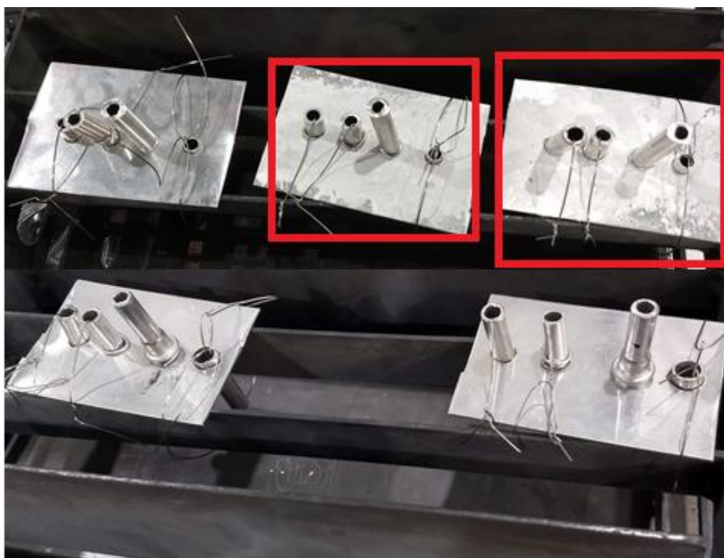
obr. 6-5: Rozložení trubek na konstrukci s 0 % Al 3003, jako základovou deskou (s naneseným fluxem v rámečcích)
