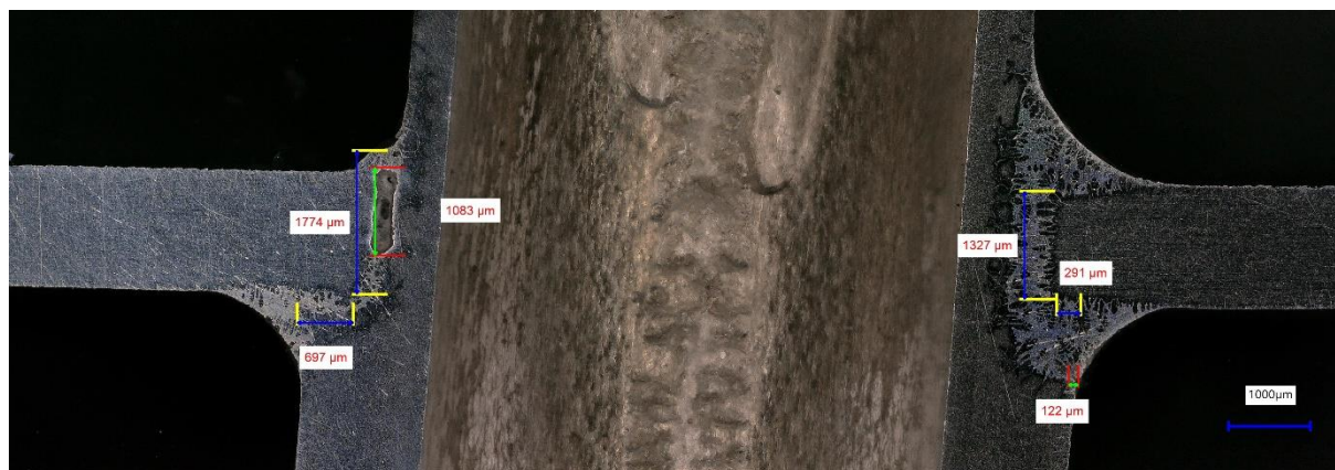
obr. 7-8: Trubka z materiálu Al 6063 a změřená délka spoje
