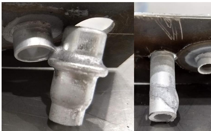
obr. 7-6: Vlevo - vypadlá trubka, vpravo - nezapájená trubka s odteklým cladem
