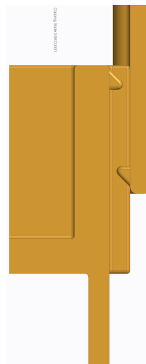
Obrázek 5.2: Zábrany proti samovolnému uvolnění
