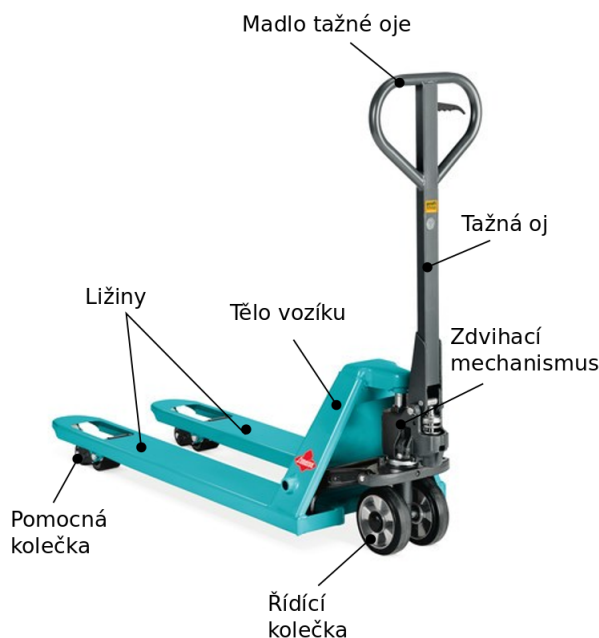
Obrázek 1.1: Popis částí paletového vozíku (převzato z [11])
