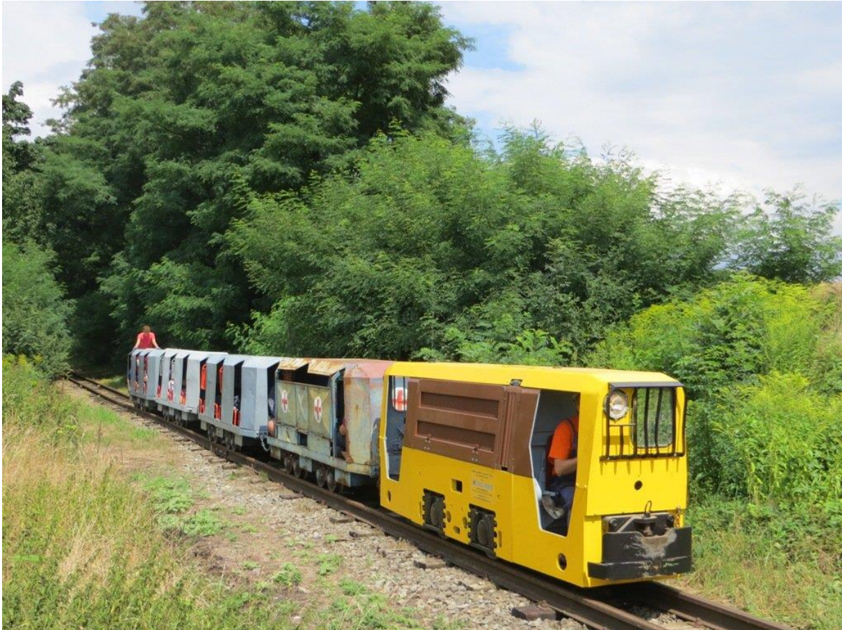
Obrázek 2: Zrenovovaná důlní lokomotiva DH 30 D.0 na testovací jízdě [3]
