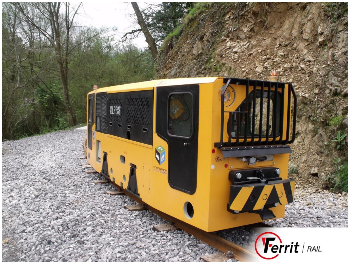
Obrázek 5: Fotografie dieselové motorové lokomotivy DLP50F [6]
