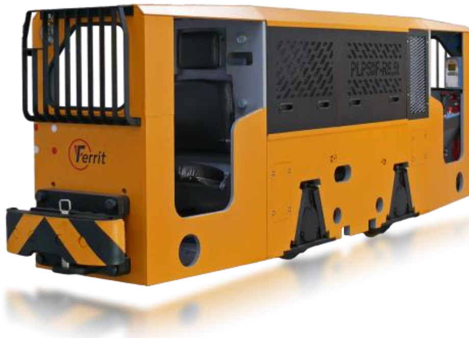
Obrázek 4: Fotografie dieselové motorové lokomotivy PLP50F-R6,5t [5]
