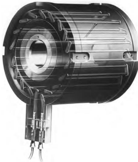
Obr. 2-4 Třívrstvý kontejner s indukčním zahříváním [5]
