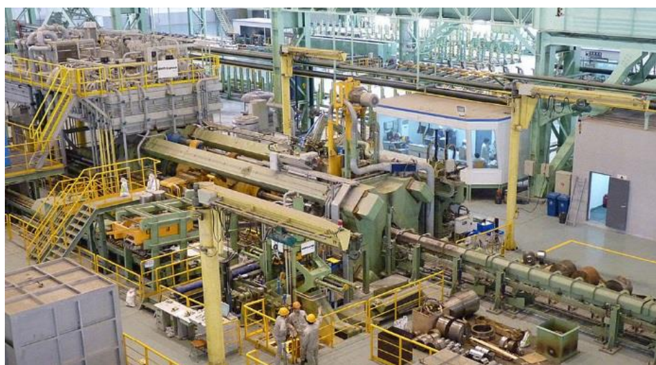
Obr. 3-3 Vytlačovací lis SMS 60 MN [14]
