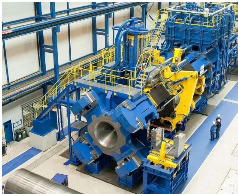
Obr. 3-4 Vytlačovací lis SMS 150 MN pro vytlačování slitin hliníku [14]
