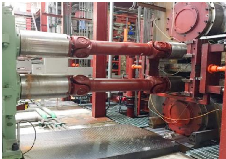
Obrázek 4-2 Připojení pohonu k pracovním válcům pomocí kardanové hřídele [22]
