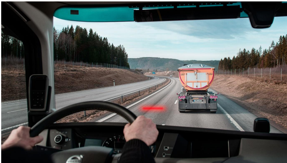
Obrázek 10 - Výstražné světlo upozorňuje řidiče na nedodržení dostatečné vzdálenosti; zdroj: www.volvotrucks.co.uk
