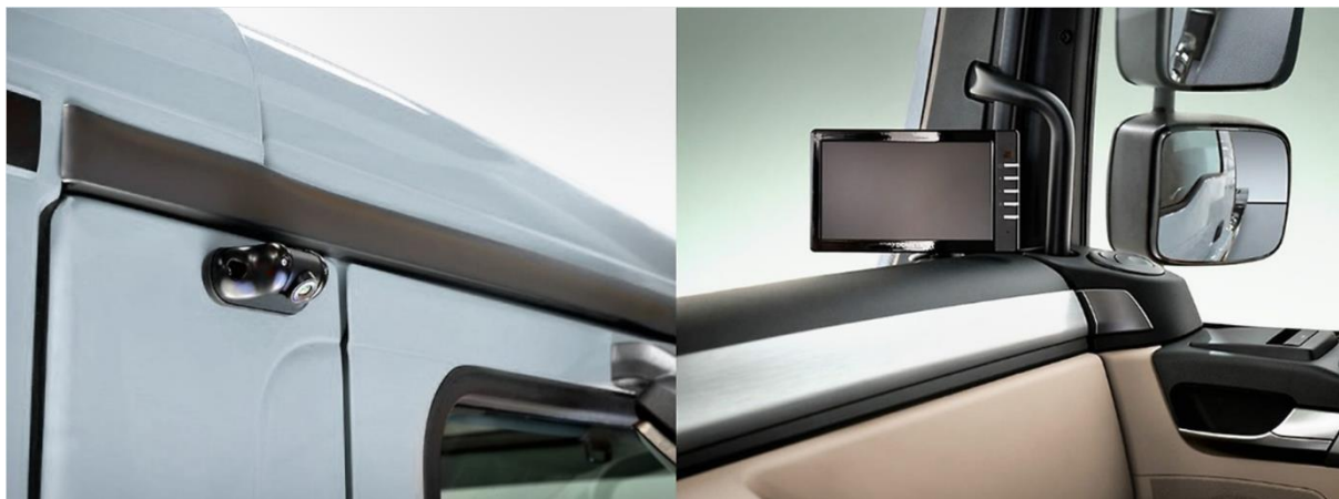
Obrázek 16 - Kamera a přidavný displej systému VAS; zdroj: www.truck.man.eu
