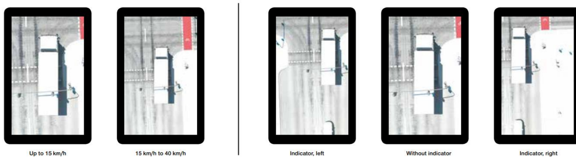
Obrázek 17 - Přenesený obraz systému MAN BirdView, vlevo ukázka přizpůsobení obrazu v závislosti na rychlosti, vpravo ukázka přizpůsobení obrazu v závislosti na použití směrového světla; zdroj: www.truck.man.eu
