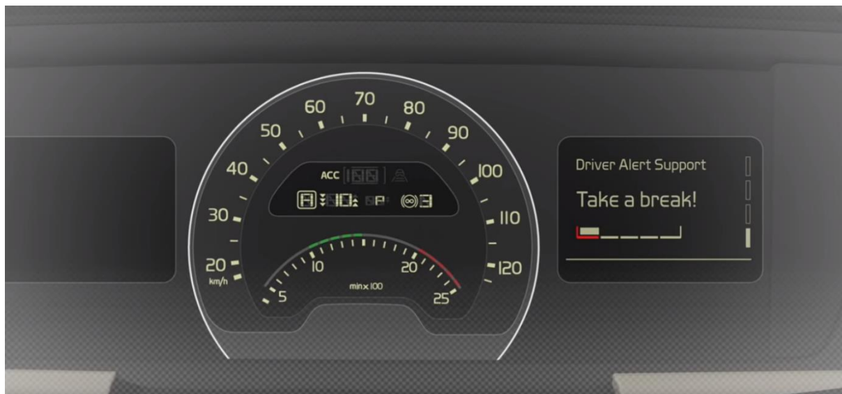
Obrázek 21 - Informační displej signalizující nízkou úroveň pozornosti řidiče, zdroj: www.volvotrucks.com
