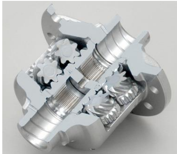
Obrázek 8: Řez sestavy diferenciálu Torsen typu A [3]
