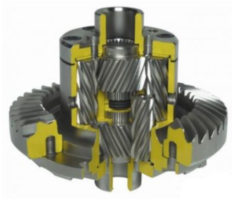
Obrázek 12: Řez samosvorným diferenciálem firmy Quaife [8]
