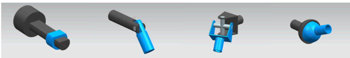
Obrázek 6-3 Typy kloubů (zleva doprava P, R, U, S)
