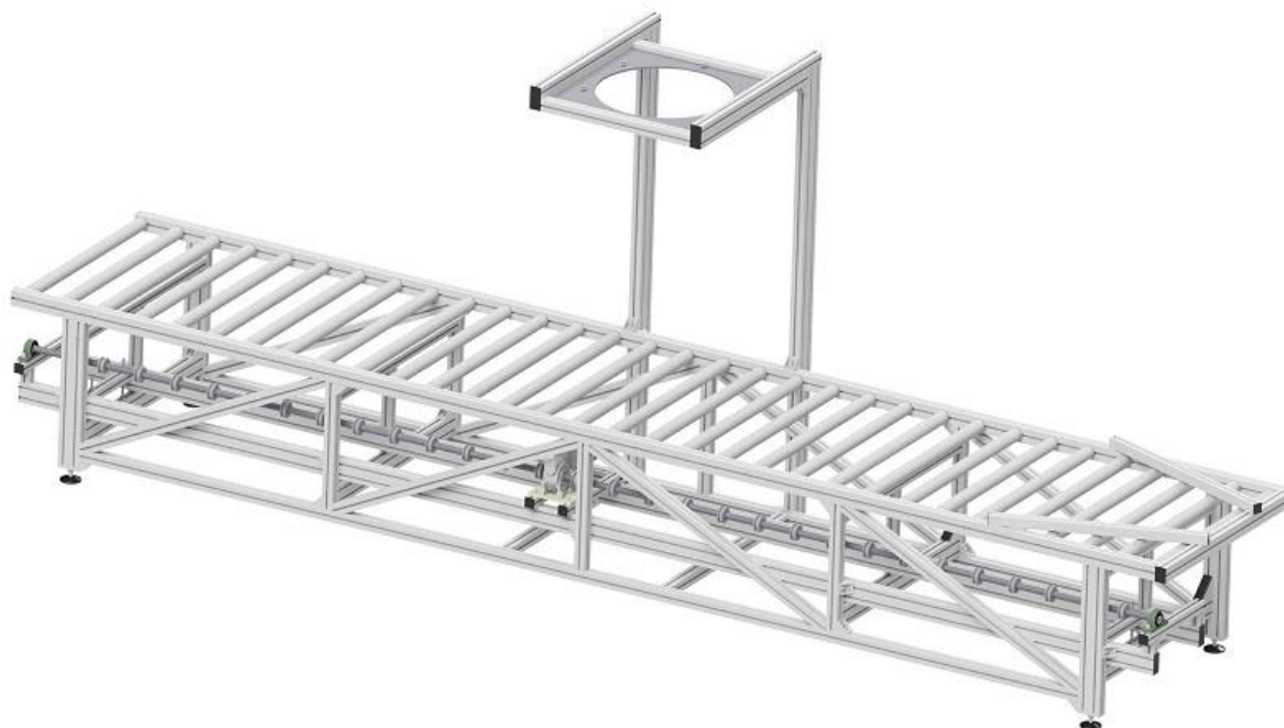
Obr. 3 Válečkový dopravník s rámem z hliníkového konstrukčního systému Alutec KK [5]
