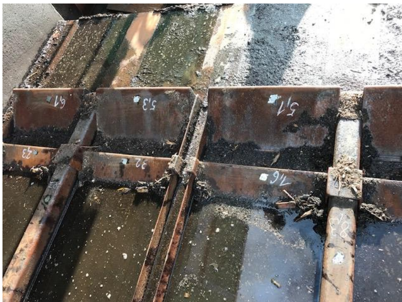
Obrázek 5-1 Měření tloušťky hrotů vyhrnovacího žebříku denního skladu paliva [autor].
