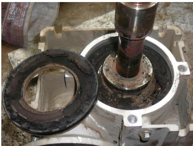
Obrázek Příloha č.1-5 Převodovka dopravníku popele – zanesení popelem[autor].
