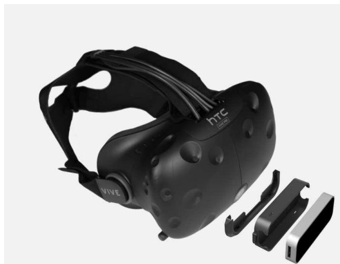
Obr. 14 Schéma připevnění Leap Motion na brýle HTC Vive [30]
