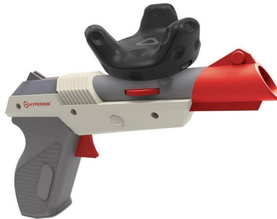
Obr. 12 Příklad upevnění HTC Vive Tracker na herní zbrani [22]
