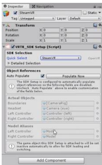
Obr. 30 Nastavené skriptu SDK Selection objektu SteamVR
