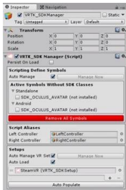
Obr. 31 Přiřazení ovladačů do skriptu VRTK_SDKManager
