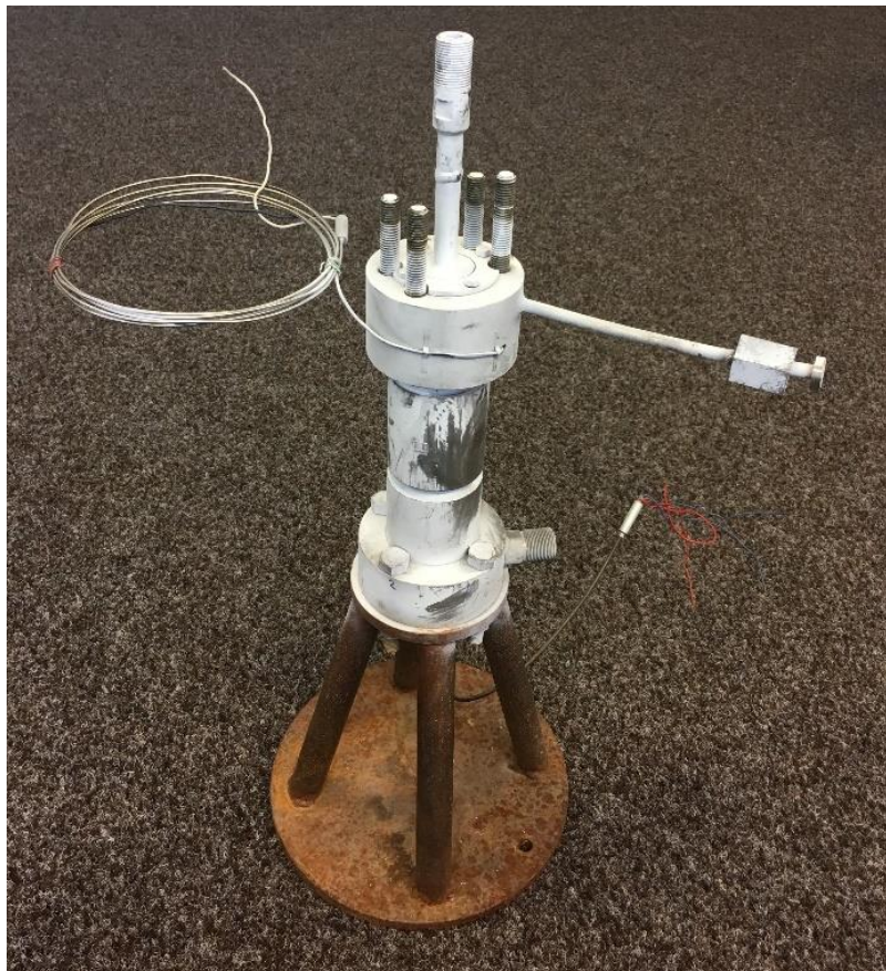
Obr. 28 Stent pro zkoušení těsnění chlazení pohonu regulačních tyčí
