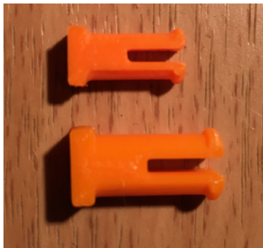
Obrázek 8 Porovnání pinu bez a se zvětšením
