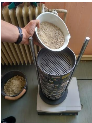
Obr. 2-10 Vysypání zkušební navážky (vlastní zpracování)
