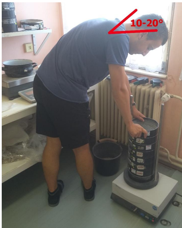
Obr. 3-3 Zvedání síta s frakcí (vlastní zpracování)
