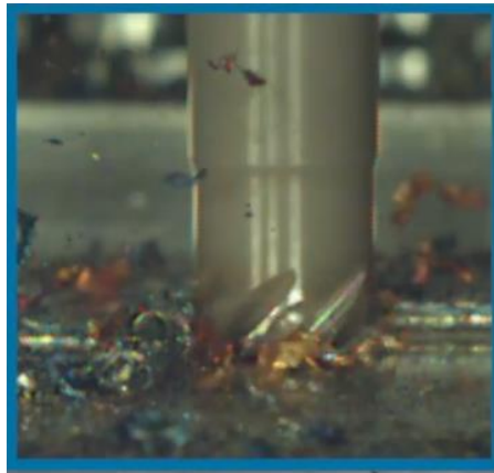
Obr. 10 - Monolitní keramická fréza ISCAR [23]
