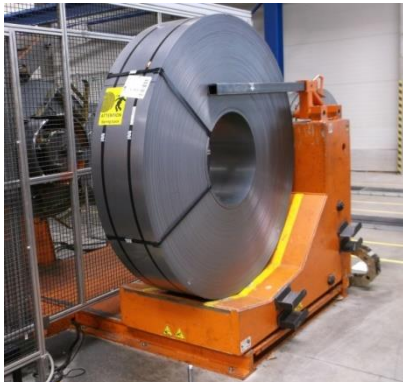
Obrázek 10: Pomocné zařízení při výměně cívky
