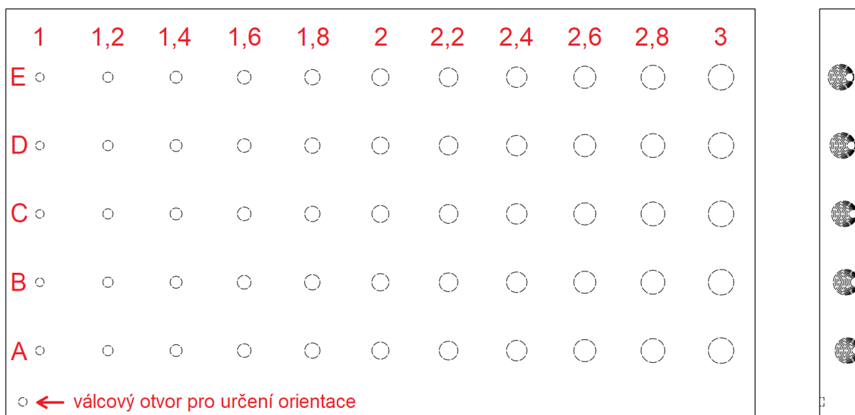
Obr. 2 Schéma umístění defektů typu jednotlivé kulové póry
