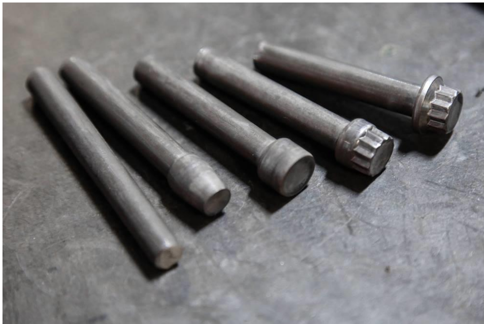
Obr. 13: Postupné tvářením hlavy šroubu
