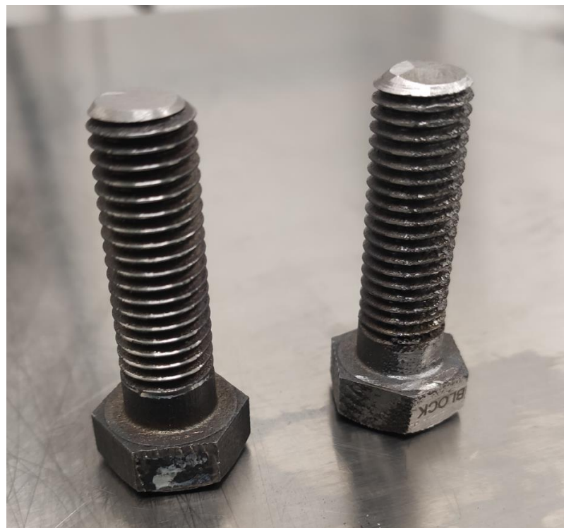
Obr. 25: 2. tisk – line s žebry (vlevo), block (vpravo)
