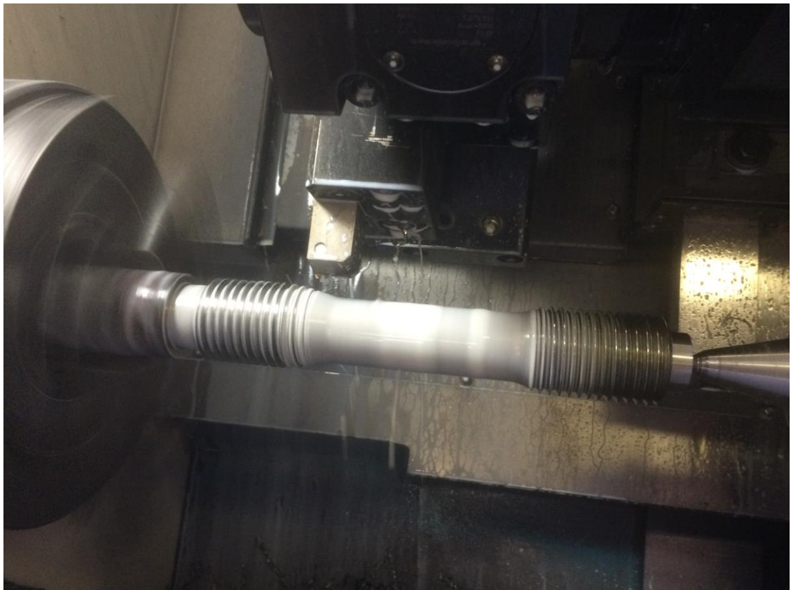
Obr. 20: Obrábění závitu závitové tyče
