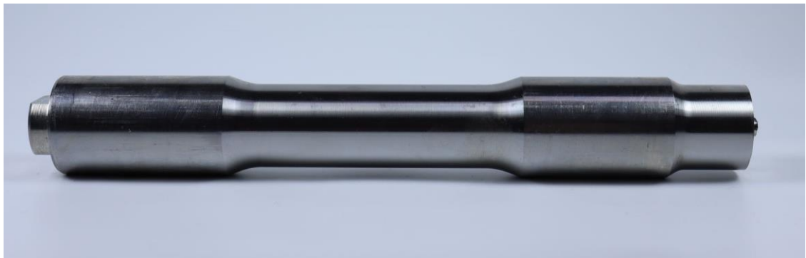
Obr. 16: Polotovary pro válcování závitu
