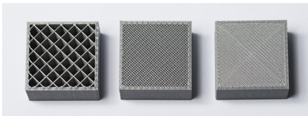
Obr. 7: Výplň struktury block [18]
