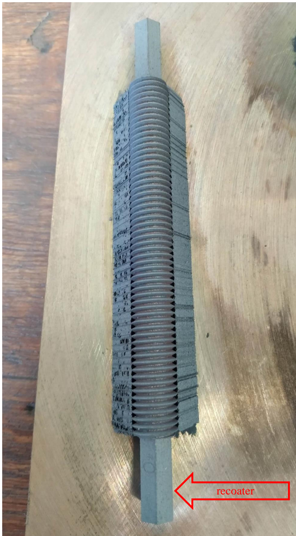
Obr. 33: Porovnání poškození podpor
