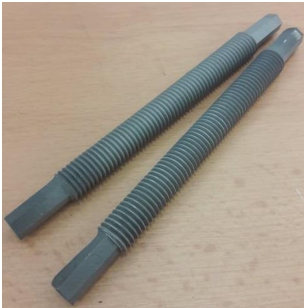
Obr. 47: Pískované vzorky - bez přídavku (vpravo), s přídavkem (vlevo)
