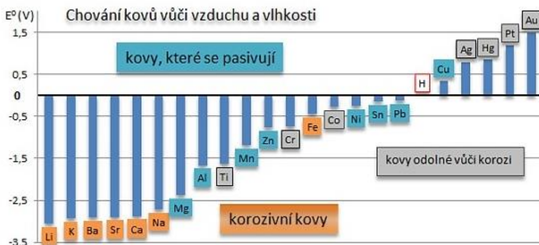
Obrázek 2 Řada napětí kovů a jejich odolnost vůči korózi [5]
