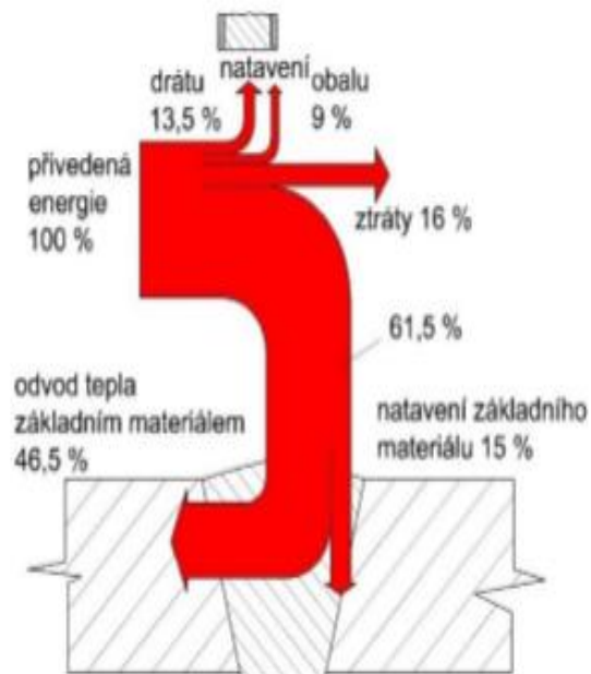
Obrázek 17 Energetická bilance při svařování austenitických ocelí [15]
