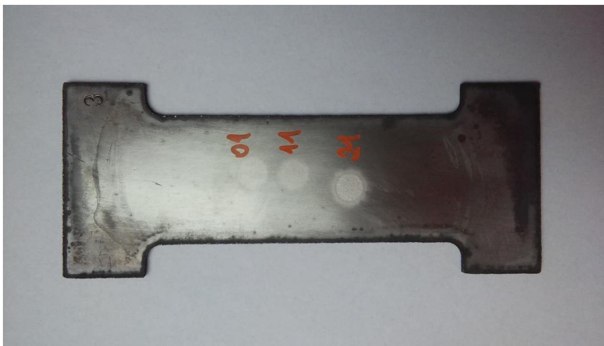
Obrázek 52 Detailnější pohled vzorku 3 po naleptání kyselinou šťavelovou
