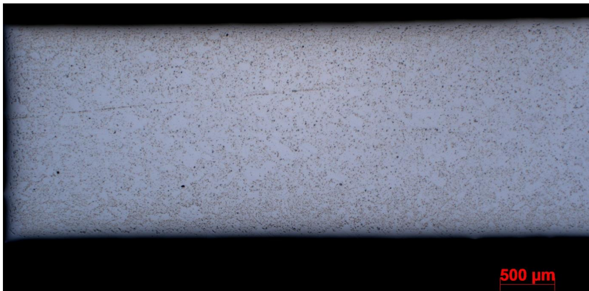
Obrázek 56 Vzorek 3 - Strauss test-dle normy zvětšení 25x
