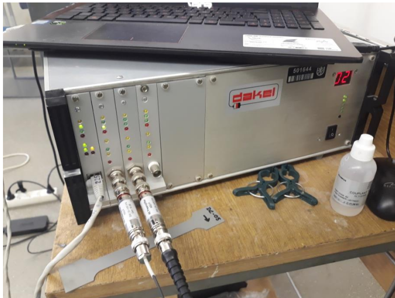
Obr. 28 - Zařízení pro měření akustické emise XEDO.
