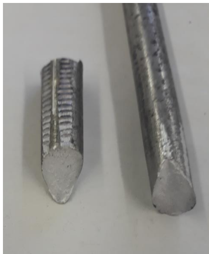
Obr. 39 - Materiál 2024 - křehký lom.
