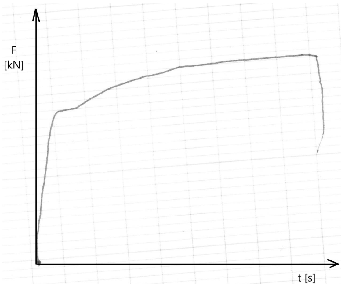
graf 5 - Tahová zkouška HX340 - tvářeno v podélném směru.
