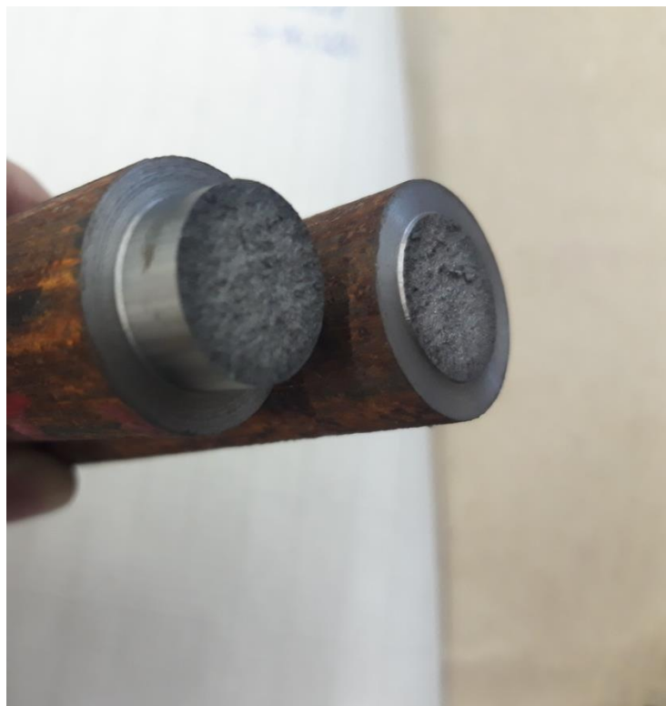
Obr. 44 - Křehký lom šedé litiny s lupínkovým grafitem.
