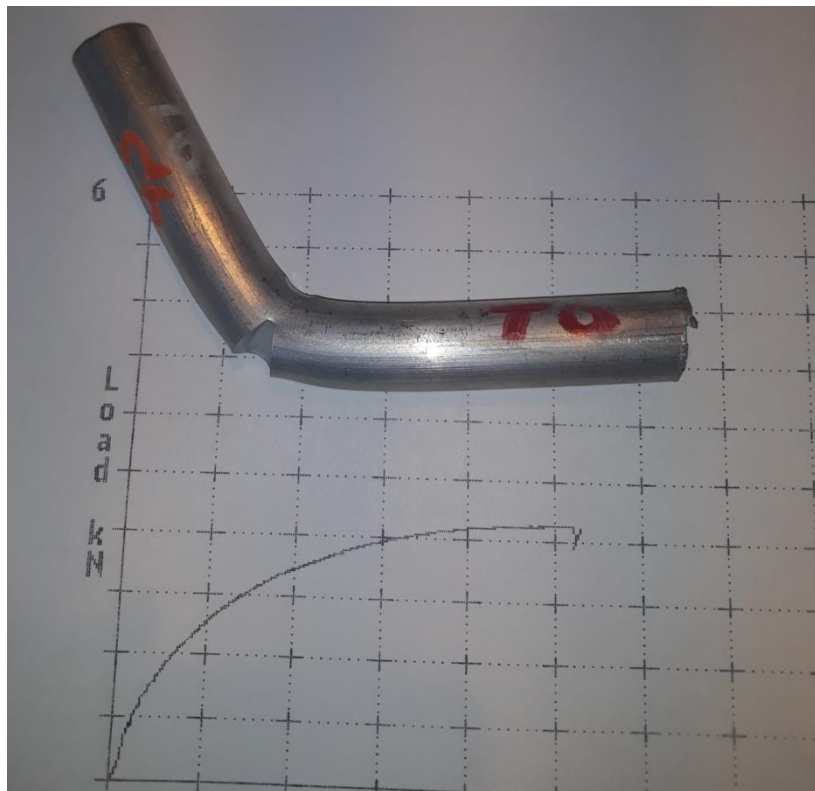
Obr. 51 - Vzorek 6063 T6 s vrubem 4,5mm namáhaný na ohyb.
