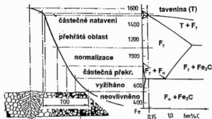
Obr. 1: Charakteristická pásma tepelně ovlivněné oblasti [41]
