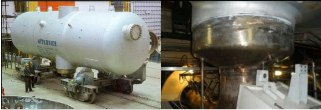
Obr. 3: Parogenerátor PGV 213 - JE typu VVER 440 (EDU); (vlevo) celkový pohled na PG; (vpravo) HSS DN 1100 kolektoru PG [12]
