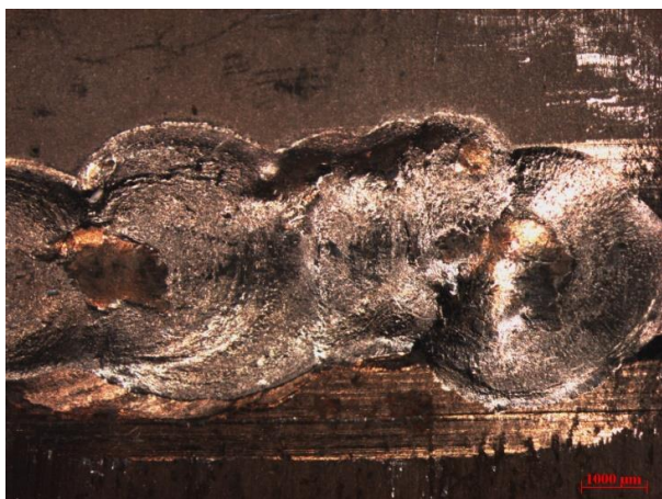
Obr. 25: Vnitřní strana svaru trubky 2A
