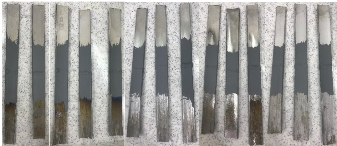
Obr. 28: Nátěrová hmota aplikovaná na vnitřní stranu svaru
