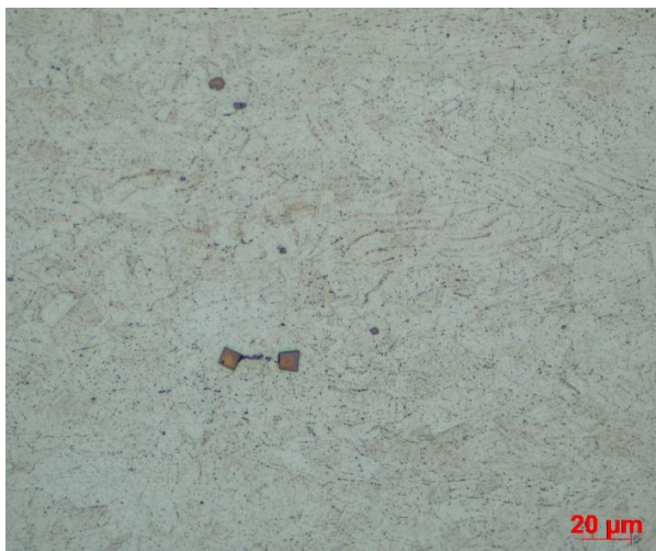
Obr. 31: Oblast daleko od svaru (500x)
