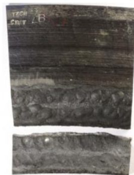
Obr. 5: Odříznutý vzorek 2B v dodaném stavu: oběalíce „průchozí“ trhliny [11]
