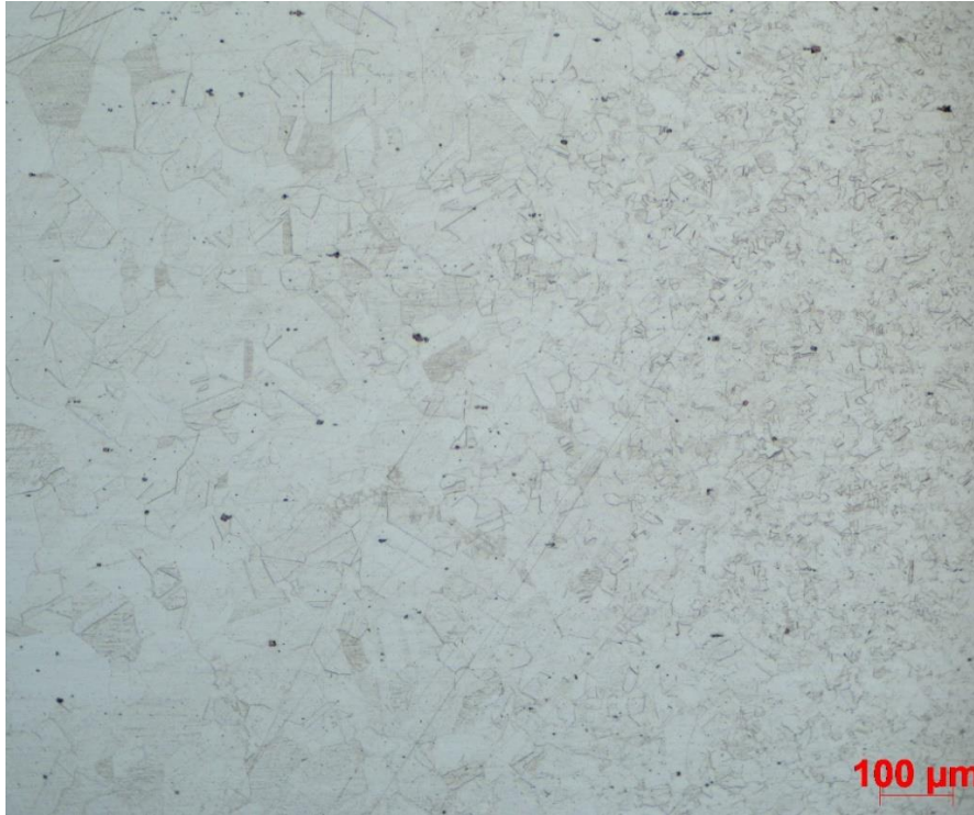
Obr. 33: Tepelně ovlivněná oblast (TOO), (100x)
