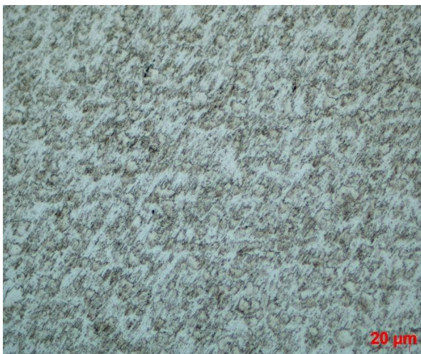
Obr. 34: Uhlíková ocel dál od svaru (500x)
